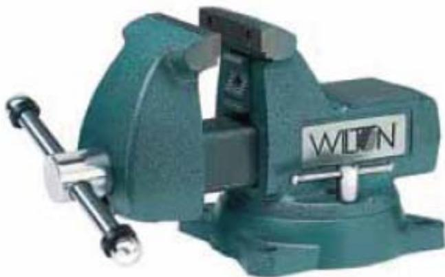
Массивная конструкция из чугунного литья с поворотным основанием на 360° и без него. Корпус покрыт порошковой краской. Эти тиски отличаются повышенной износостойкостью, и чаще используются заводами и предприятиями. Губки для зажима цилиндрических прутков, стандарт (сменные). Усилие зажима 2100 кг/см<sup>2</sup>. Наковальня.
