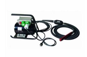
Степень уплотнения можно контролировать по внешнему виду поверхности смеси. У качественно уплотненной смеси она должна быть плоской и гладкой, выделение пузырьков воздуха должно отсутствовать.
